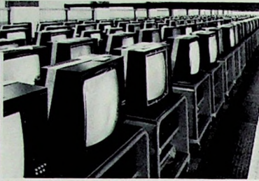
Das vollautomatisch bestückte Dauerprüffeld kann in 14 nebeneinanderliegenden Bahnen bis zu 1000 Geräte für einen 24stündigen Dauerbetrieb aufnehmen
